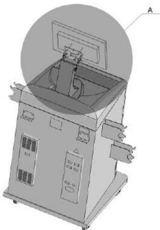
1. Демонтировать фланец с кронштейна, вывернув винты М6х16.
