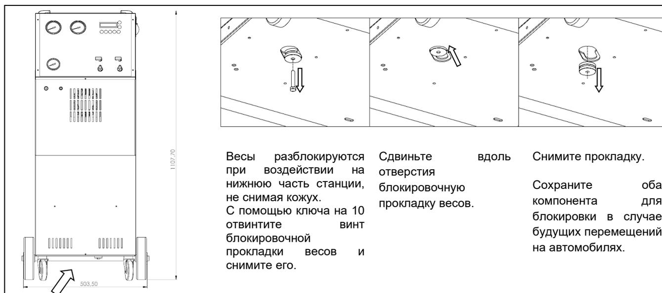
Весы разблокируются при воздействии на нижнюю часть станции, не снимая кожух. С помощью ключа на 10 отвинтите винт блокировочной прокладки весов и снимите его.
